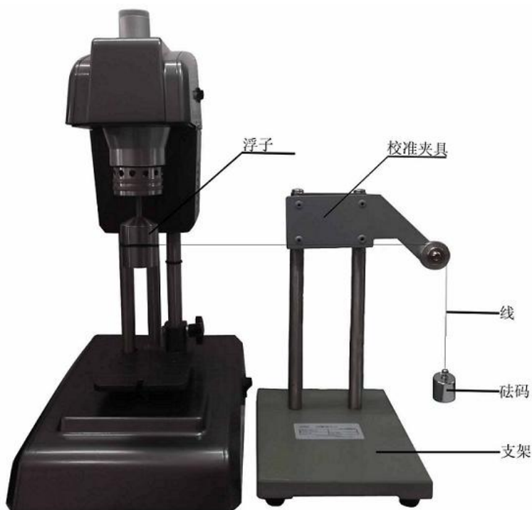
图（5）静负载校准装置 Diagram (V) Static load calibration device
